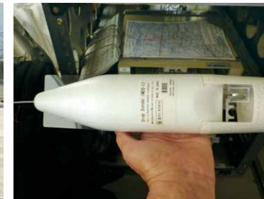
新しく開発したドロップゾンデ (Meisei Electric Co., Ltd. and Nagoya University)
