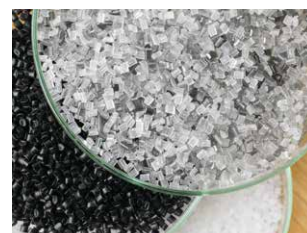
カーボンナノチューブをはじめとする高機能素材を樹脂に混ぜ込むことで、高い分散性を誇る世界最高品質のペレットの開発に成功
