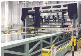
異常検知AIにより航空機の外板の微細な傷をスクリーニングする技術を開発し、大型の装置に導入開始
