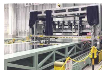
異常検知AIにより航空機の外板の微細な傷をスクリーニングする技術を開発し、大型の装置を導入開始
